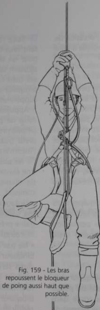
Fig. 159 - Les bras repoussent le bloqueur de poing aussi haut que possible.
